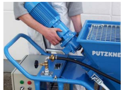
Der Pumpenmotor wird zur Reinigung das Mischrohrs abgeklappt. Zum Transport wird er abgenommen.
