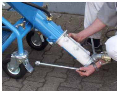
Oben: leicht abnehmbares Pumpenteil
